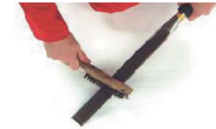
2 LIMPIEZA PLANCHA METALICA
